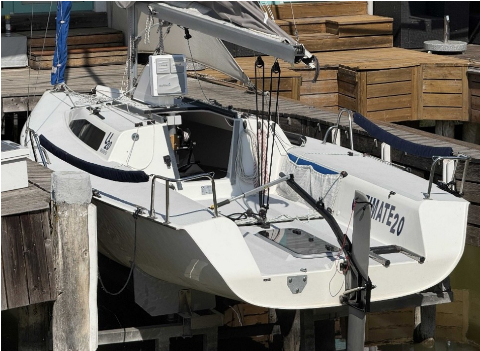
Hybridruder (kombiniertes Steck-Klappsystem) für tiefes und seichtes Wasser
