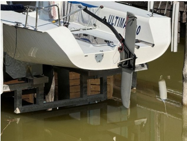
Hybridruder (kombiniertes Steck-Klappsystem) für tiefes und seichtes Wasser
