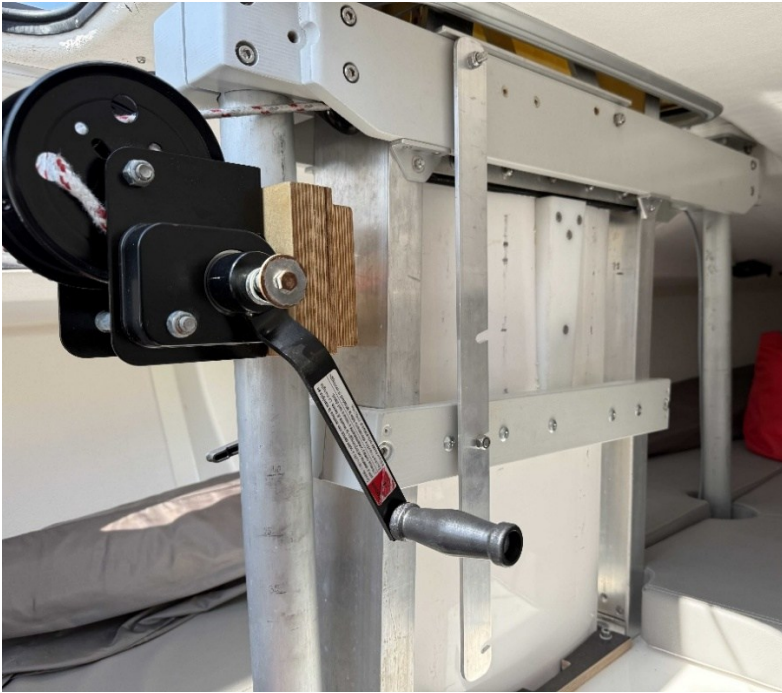
Kielhebeeinrichtung ermöglicht stufenlose Anpassung an Wassertiefe
