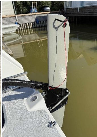
Hybridruder (kombiniertes Steck-Klappsystem) für tiefes und seichtes Wasser
