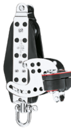
Typ HK1564 Violinblock mit Wirbel, Klemme und Unterbügel 2-scheibig
