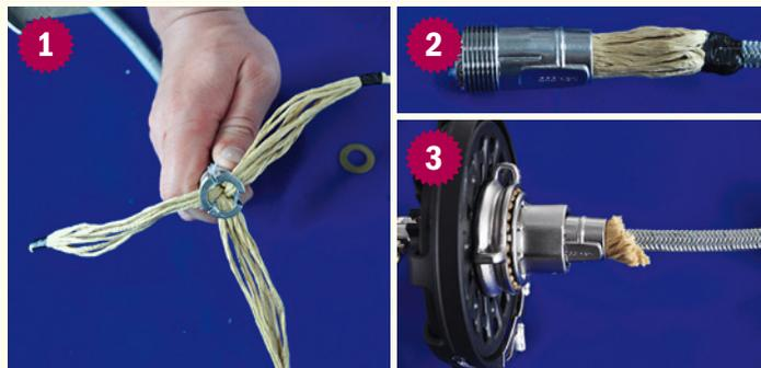
Der Kern der Liros-AT-Leine wird geteilt und jedes Drittel durch ein Konusteil geführt (1). Dann schiebt man die Schraubhülse so weit wie möglich über den Konus (2). Die Hülse wird fest in das Terminal eingeschraubt und mit zwei Madenschrauben gesichert (3)
