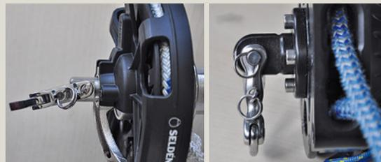
Der Schäkel an der Trommel von Seldén (li) verhindert ein vollständiges Kippen der Trommel. Bei Bamar (re) kann die Trommel bei Zugentlastung kippen
