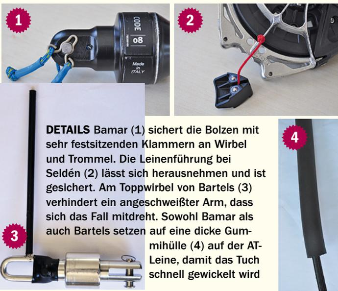
**DETAILS** Bamar (1) sichert die Bolzen mit sehr festsitzenden Klammern an Wirbel und Trommel. Die Leinenführung bei Seldén (2) lässt sich herausnehmen und ist gesichert. Am Toppwirbel von Bartels (3) verhindert ein angeschweißter Arm, dass sich das Fall mitdreht. Sowohl Bamar als auch Bartels setzen auf eine dicke Gummihülle (4) auf der AT-Leine, damit das Tuch schnell gewickelt wird
