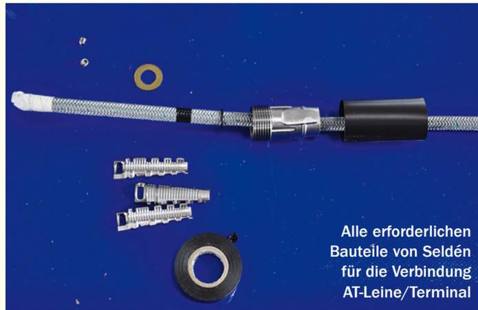
Alle erforderlichen Bauteile von Seldén für die Verbindung AT-Leine/Terminal
