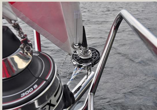
Mit vielen Einstellmöglichkeiten an der Trommel lässt sich die Zugrichtung der Bedienleine justieren
