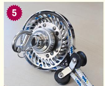
**Bedienleine einfädeln: 3) in Trommelaussparung legen, 4) in die Trommel drehen, 5) Leinenführung schließen**
