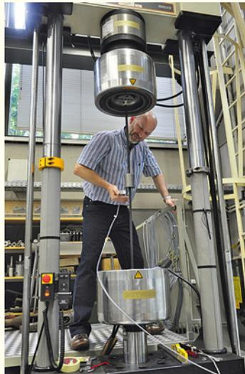
Ebenfalls an der TU spannten wir die Antitorsions-Leinen in die Prüfmaschine und ermittelten die Kraft, die zum Verdrehen der Leinen nötig war (li). Aufbau der verschiedenen AT-Leinen (re)
