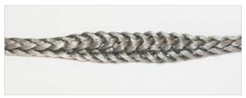
Schieben Sie das Seil zusammen, dadurch wird es gelockert und das Spleißen vereinfacht.
