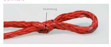
... und ziehen Sie das Auge vollständig durch.
