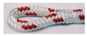
Ziehen Sie an dem Spleißauge, damit der Kern vollständig im Spleiß verschwindet. Wenn notwendig, können Sie ein Takling setzen!
