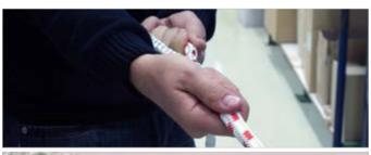
Hängen Sie den Knoten aus Schritt 9 an einen gut verankerten Haken und streifen Sie den Mantel schrittweise in Richtung Spleißauge.
