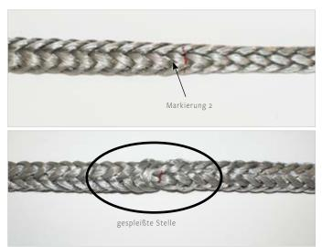
Zum Schluss sollte an beiden Seiten, an der Markierung 2, kein Seilende mehr herausragen.
