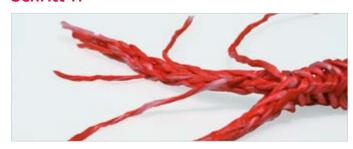
Entfernen Sie das Klebeband und verjüngen Sie das Seilende dahingehend, dass 30% - 50% der Litzen in regelmäßigen Abständen aus dem Seilende gezogen und abgeschnitten werden.
