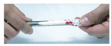
Führen Sie die abgeklebte Mantelspitze in die Spleißnadel wie links angefügt.
