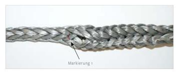
Machen Sie bei der Markierung 1 mit Hilfe des Fingers oder einer Spleißnadel eine Öffnung.
