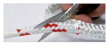
Schneiden Sie in ca. 15 cm Entfernung von der Übergangstelle den Mantel schräg ab und streifen Sie den Kern über den Mantel, sodass der Mantel vollständig im Kern verschwindet.
