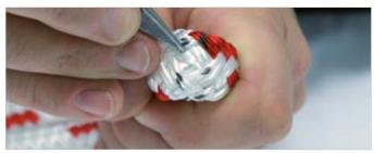
Knicken Sie das Seil bei Markierung II und öffnen Sie mit Hilfe einer Ahle den Mantel.
