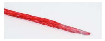
Formen Sie das Seilende zu einer Spitze und umwickeln Sie diese mit einem Klebeband.
