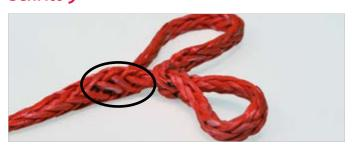
Stecken Sie das angespitze Ende in das Seilinnere. Führen Sie nach 30 cm das angespitzte Ende wieder aus dem Seilinneren (siehe nächstes Foto)
