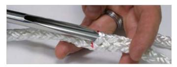
Stechen Sie die Spleißnadel bei Markierung 2 in den Kern und führen Sie die Nadel in Richtung Markierung 3.
