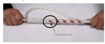
Ziehen Sie mit beiden Händen an den abgeklebten Enden (Kern und Mantel) Achten Sie darauf, dass die Übergangsstelle fest zusammengezogen wird.
