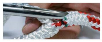
Führen Sie die abgeklebte Kernspitze in die Spleißnadel. Stechen Sie die Spleißnadel bei Markierung 1 in den Mantel und führen Sie die Nadel in Richtung Markierung 2.
