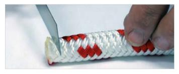
Bei einem verschweißten Seilende muss spätestens jetzt dieses Ende mit einem scharfen Messer abgeschnitten werden.
