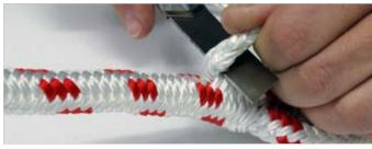
Ziehen Sie den Kern in Richtung Auge und schneiden Sie diesen sehr knapp bei der Austrittstelle ab. Achten Sie darauf, beim Abschneiden den Mantel nicht zu verletzen.
