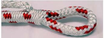
Das Spleißauge sollte aussehen wie links angefügt.
