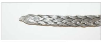
Spitzen Sie die beiden Seilenden mit einem Messer an und umwickeln Sie es mit Klebeband. Bei harten Seilen ist das Seil gleichzeitig das Spleißwerkzeug, bei weichen Seilen kann eine Spleißhilfe (Spleißnadel, siehe Bild) notwendig sein.
