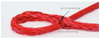
Öffnen Sie Seil bei der Markierung 46 cm mittig und stechen Sie das Seilende durch diese Öffnung bis zur Markierung 30 cm. Dies ist die erste Öffnung.
