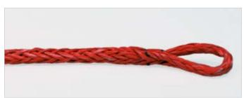
Streifen Sie den Spleiß glatt, sodass das verjüngte Seilende im Inneren des Seiles verschwindet.
