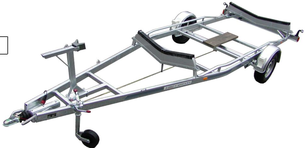
**Serienmäßige Ausstattung:** Stahltrailer verzinkt, **Einfachrahmen, extra lang**, Trailerbreite 2250mm, Auflaufbremse mit Rückfahrautomatik, 50 mm Kugelumkupplung, Wasserdichte Radnaben, Querauflagen, Bugstütze, Schwertauflegebrett, Stützrad, Bereifung 14", Beleuchtungsanlage 12 Volt nach EU, Elektrostecker 13-polig, Zulassungsunterlagen („COC“) und Trailer-Datenpass
