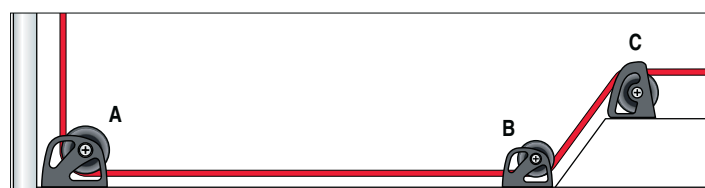
Over the Top: Besondere 'over-the-top' Blöcke kommen zum Einsatz, gilt es eine Aussenkante zu überwinden, wie die Vorderseite des Luken-Gehäuses oder das Süll.
