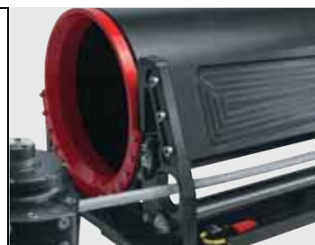
Hydraulische Versionen haben offene Ende, um das Gewicht zu reduzieren.
