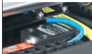
Redundante Näherungs-Schalter verhindern Über-Lauf.
