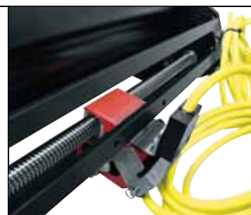
Die Schnecken-Konstruktion bringt den Antrieb nah an die Trommel, was die Winsch-Grösse reduziert.
