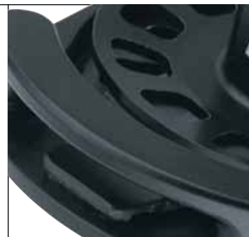
Endlosleinen Furler haben versetzte Löcher in der Antriebsrolle um der Leine sicheren Halt zu geben.
