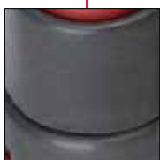
6061-T6 Aluminium: Hard Lube-eloxiert
